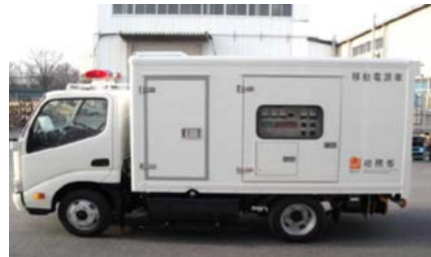
災害対策用移動電源車
